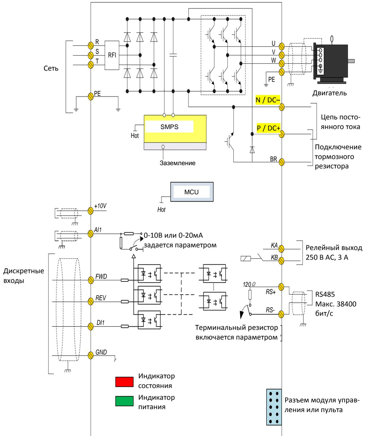
Примечание: В модуле управления PU00 нет клемм входов/выходов (RUN, / F / R, DI1, DO1, RS +, RS-) и нет индикаторов состояния.
