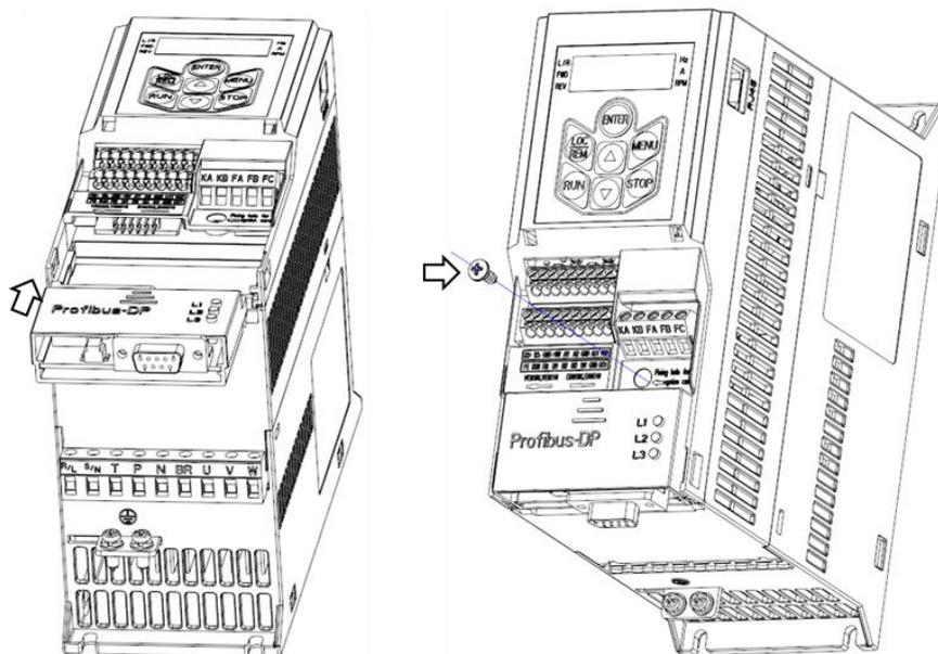
Установка плат расширения в модуль управления CU00: вставьте плату по направляющим в нижней части модуля управления до упора. Закрепите плату расширения винтом в правом верхнем углу платы. Хотя CU00 имеет встроенный пульт управления, можно подключить дополнительный (выносной) пульт (KP01, KP02) через разъем RJ45. **Обратите внимание, что если установлен дополнительный пульт, то ни встроенный пульт, ни плата расширения работать не будут.**
