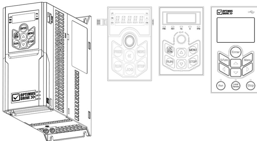
Модуль управления CU01 не имеет встроенного пульта. Пульт управления KP01 может быть установлен непосредственно в модуль CU01 (в разъем; пульт будет съемным) или подключен с помощью кабеля. KP02 может быть подключен к модулям CU00 или CU01 только с помощью кабеля. В CU01 при одновременном использовании плат расширения и пульта конфликтов оборудования не возникает.
