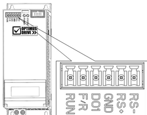
Спецификация клемм управления модуля PU01 (0.37-7.5 кВт):
