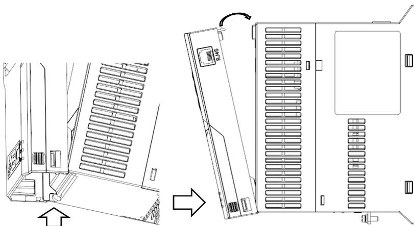
Установка модуля управления на силовой модуль: закрепите нижнюю часть модуля управления на кронштейне силового модуля, затем поднимите модуль управления к силовому модулю до защелкивания на фиксаторе.
