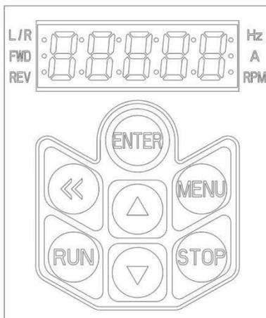
С помощью пульта пользователь может переключаться между двумя различными режимами работы: локальным и удаленным.
