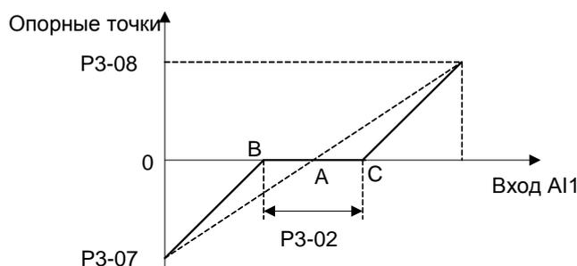
Точка A, показанная на рисунке, является аналоговым значением, которое соответствует заданному нулевому значению. Она рассчитывается с помощью аналоговых нижнего и верхнего опорных значений. После установки на AI1 зоны нулевого сигнала,  $U_{AB} = U_{AC} = P3-02 / 2$ . Если сигнал на входе AI1 находится между B и C, задание для входа AI1 равно 0.
