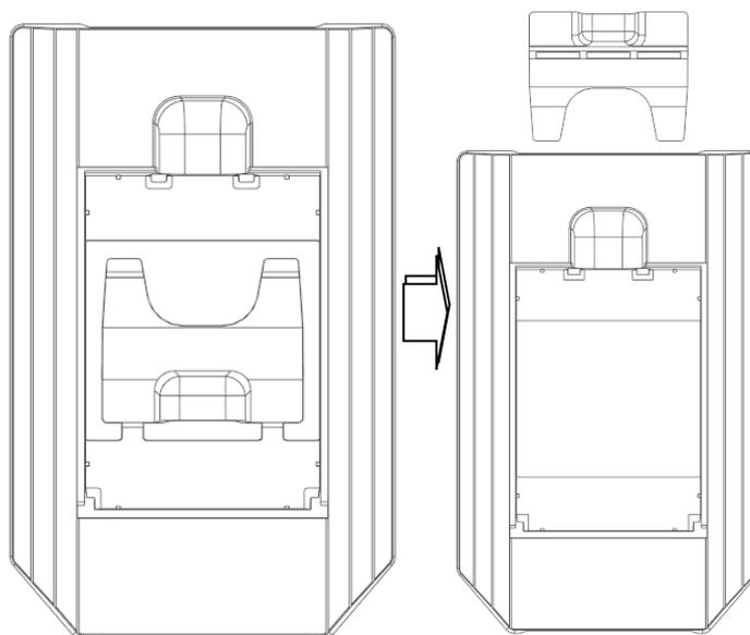
Шаг 2: Подготовка: снимите фиксатор
